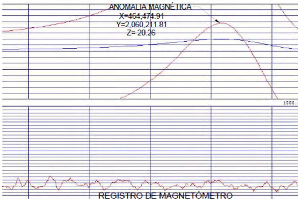
Figura 7.9. Anomalía magnética asociada a la tubería de revestimiento por arriba del lecho marino en el Pozo Hokchi-101.
