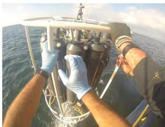
Figura 5.3. Muestreo de agua con botellas Niskin de 10 l de capacidad cada una.
