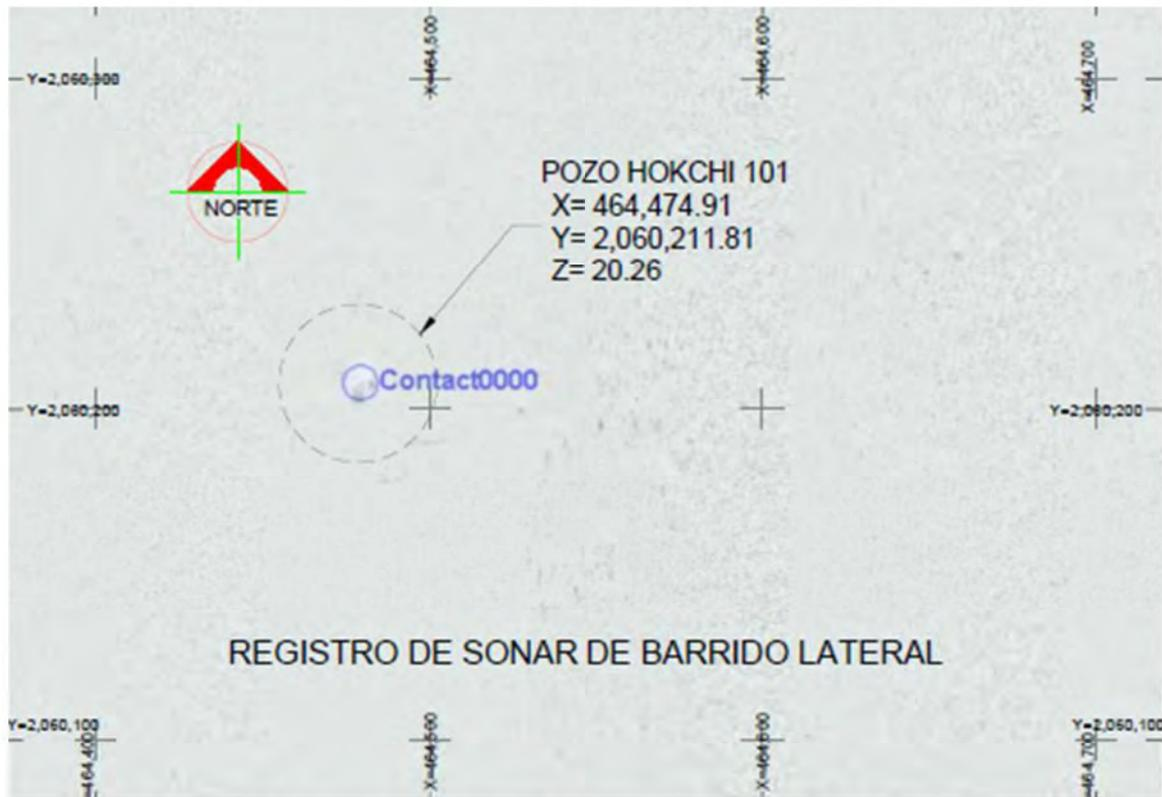
Figura 7.7. Imagen de sonar de barrido lateral donde el círculo indica la posición del pozo Hokchi-101 y la anomalía central corresponde a su ubicación.
