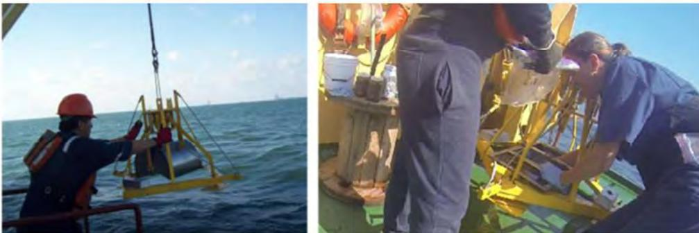
Figura 5.4. Muestreo de sedimento con una draga Smith McIntyre,
