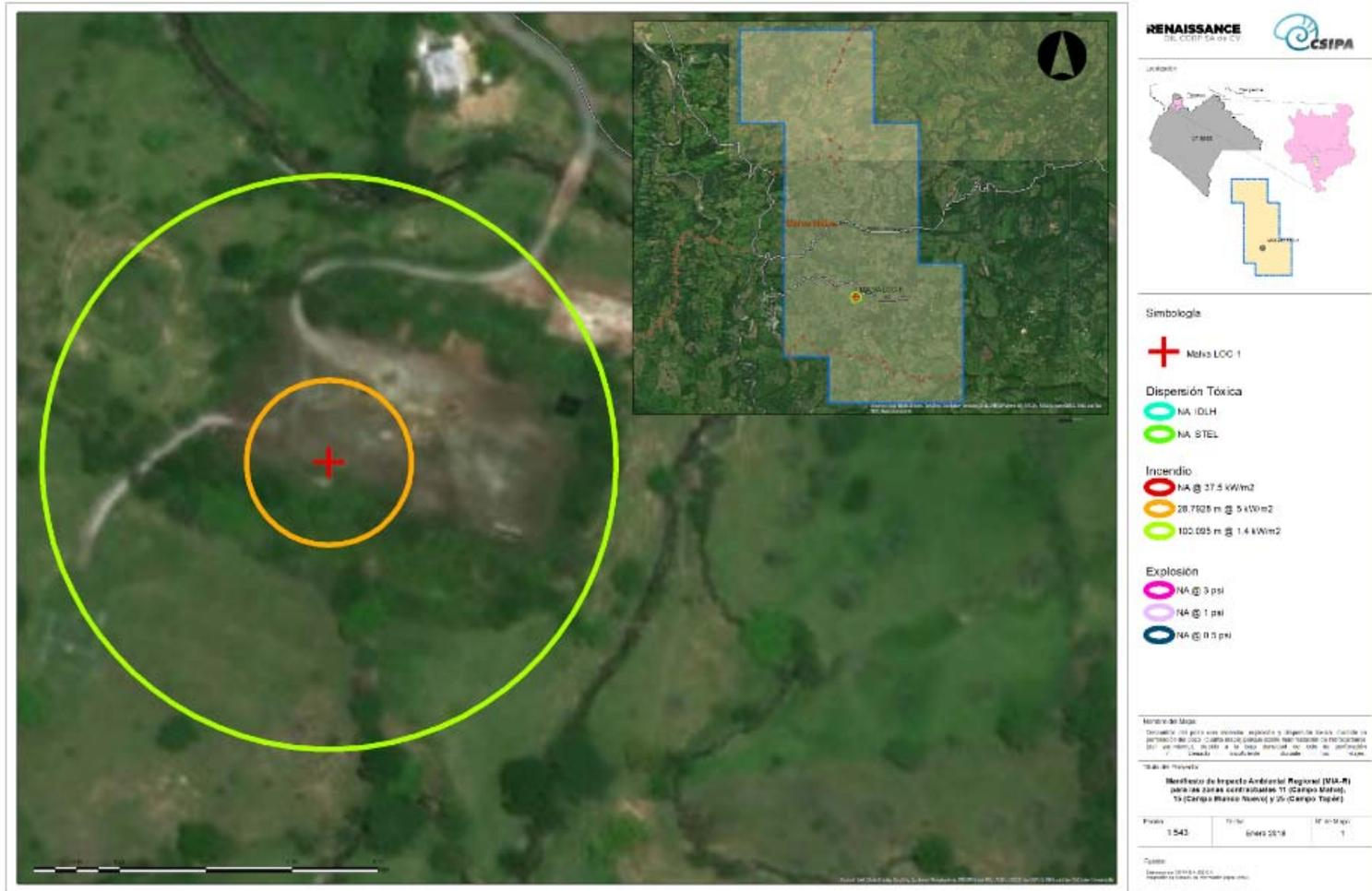
FIGURA II.1.5 RADIOS DE AFECTACIÓN DESCONTROL DE POZO CAMPO MALVA LOC-1
