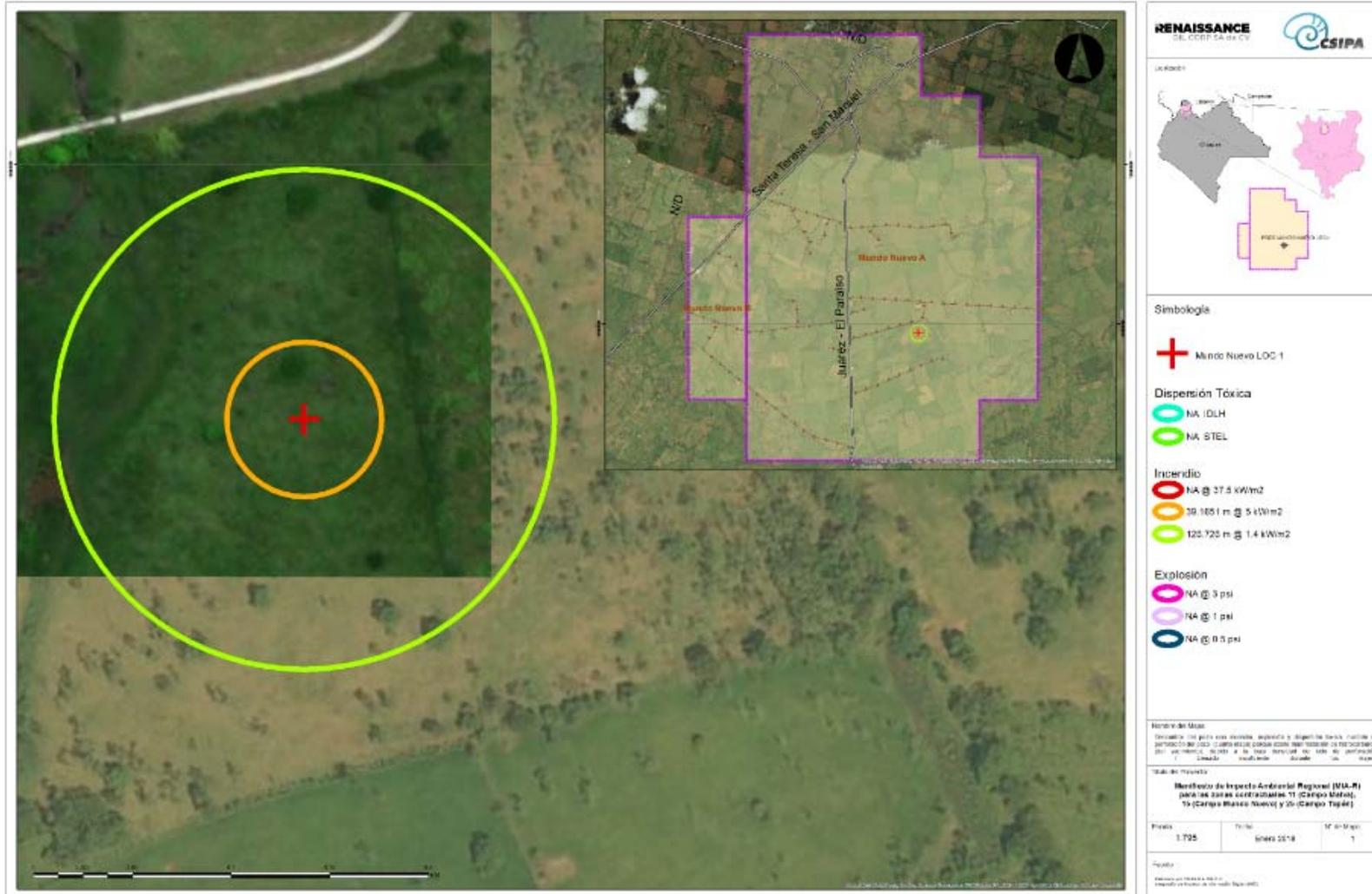
**FIGURA II.1.1 RADIOS DE AFECTACIÓN DESCONTROL DE POZO CAMPO MUNDO NUEVO**
